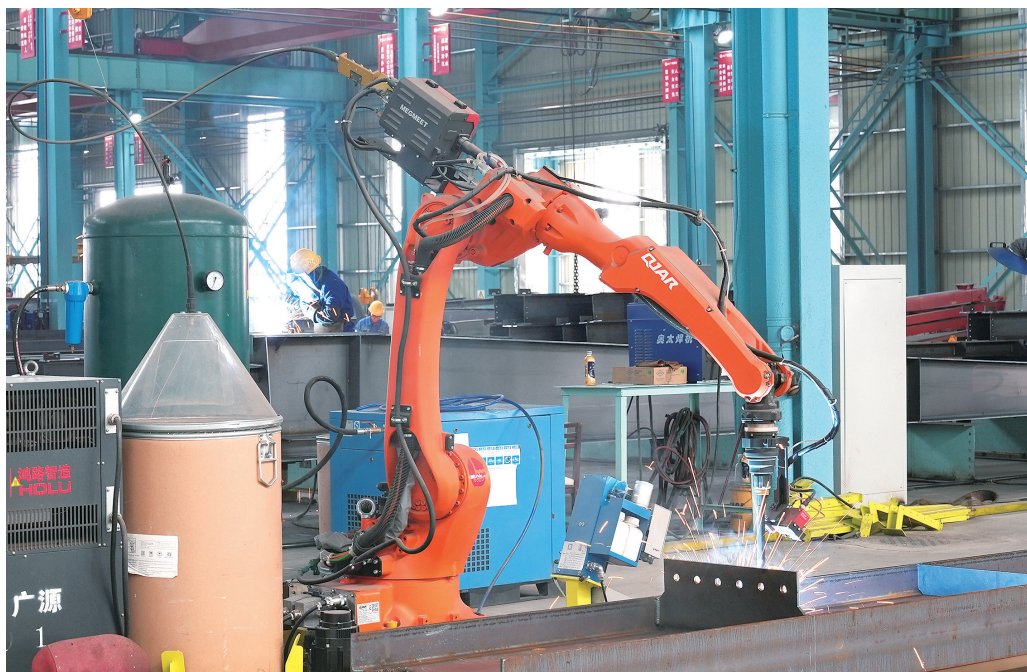
广西中广源建筑科技有限公司钢结构装配式新型建材生产及铝板深加工生产线运行中。(傅永顺 摄)
