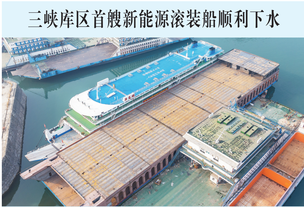
1月21日，秭归县华星船务有限公司建造的新能源滚装船在专用码头进行舾装（无人机照片）。三峡库区首艘新能源滚装船1月20日在湖北省秭归县华星船务有限公司顺利下水。该货轮是三峡集团联合交通运输部长江航务管理局共同打造的新能源运用试点示范船舶，设计载重8000多吨，采用“甲醇单一燃料发电+电力驱动”动力系统。（新华社（郑家裕 摄）
